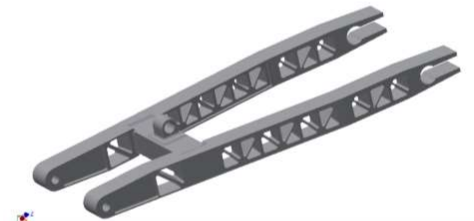
Rys. 2. Wstępny projekt wahacza.
