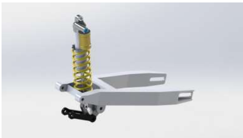
Rys. 1. Układ zawieszenia motocykla typu „linkage” z wahaczem
