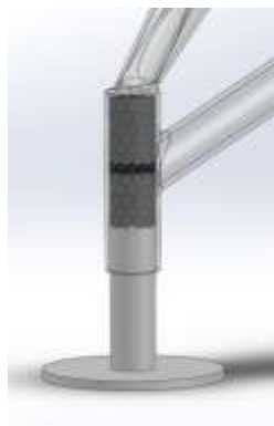
Rys.1 Absorber energii w nodze lądownika
