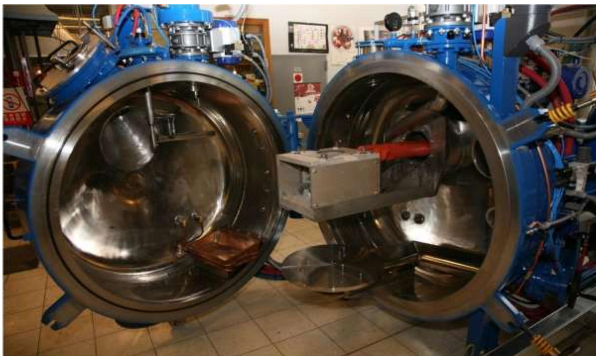
Rys. 1 Laboratoryjny indukcyjny piec próżniowy VIM 10 ÷ 20
