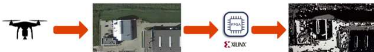
Rys. 1 Schemat zrealizowanego systemu. Na obrazie wynikowym na biało oznaczono obszary, w których lądowanie powinno być bezpieczne.
