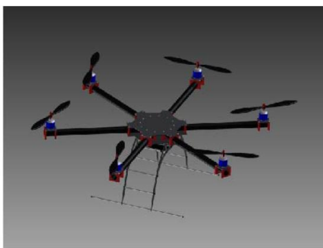
Hexacoopera - schemat poglądowy oraz model w programie Autodesk Inventor
