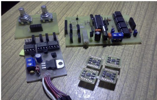
Rys. 2. Testowane moduły (enkodery, I2C, przetworniki DAC, CAD).
