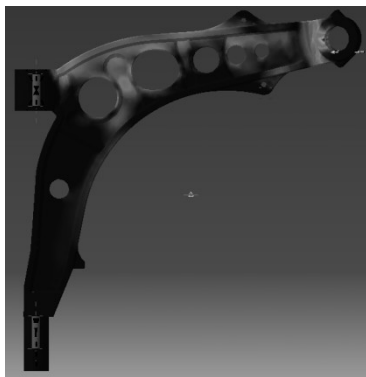
Rys. 1. Wyniki analizy wytrzymałościowej wahacza samochodowego.
