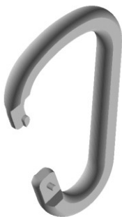
Rys. 1. a) Krzywa rozciągania dla Aluminium 7075, przyjęty bilingwowy model materiału b) geometria karabinka.
