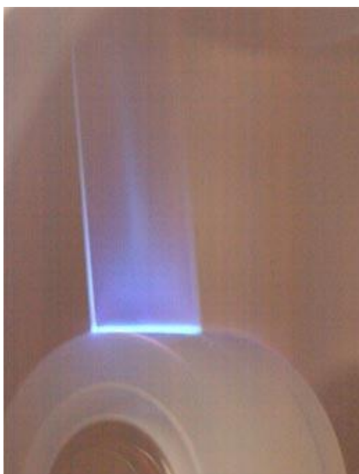
Rys. Zjawisko tryboluminescencji podczas odwijania taśmy klejącej
