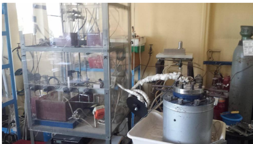
Rys. Aparatura do przeprowadzania karbonatyzacji mineralnej
