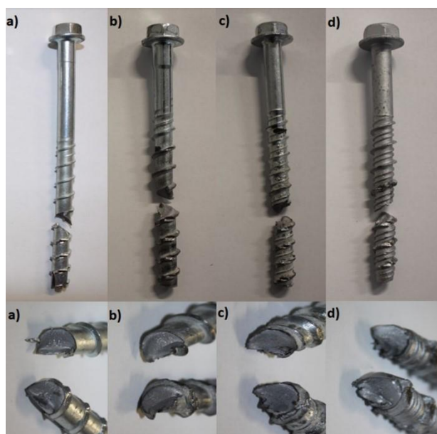
Rys. Badane kotwy po próbie statycznego rozciągania
