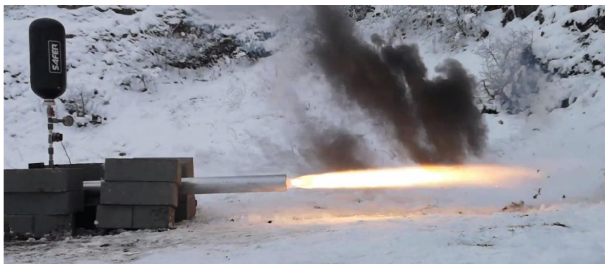
Rys. Test statyczny silnika B4
