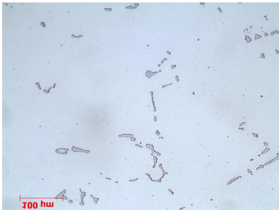
Rys. Morfologia i rozmieszczenie węglików w nadstopie IN738
