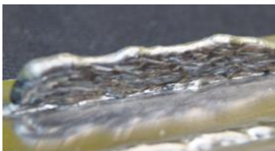
Rys. Zdjęcie napoiny wytworzonej metodą szybkiego prototypowania wiązką laserową
