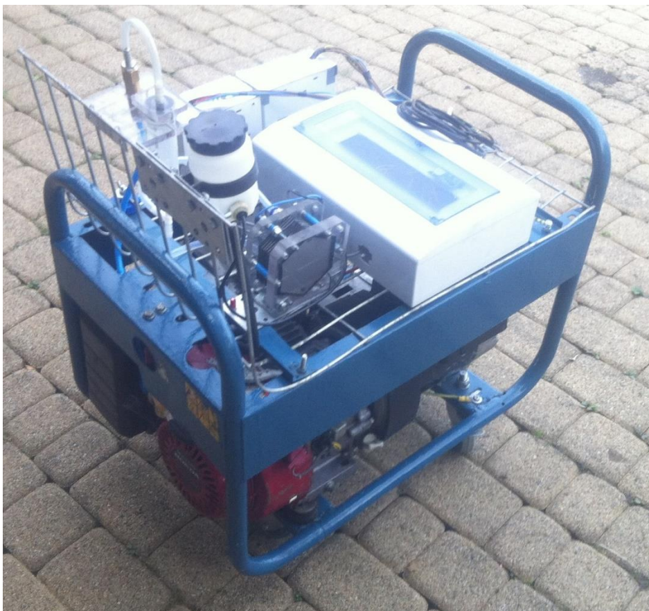
Rys. Agregat wraz z prototypowym układem zasilania wodorem
