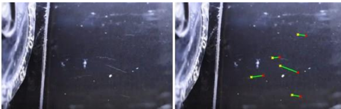
Rys. Zdjęcie śladów powstających w komorze mgłowej ze źródła radowego (po lewej) i zaznaczonymi liniami przez program (po prawej)
