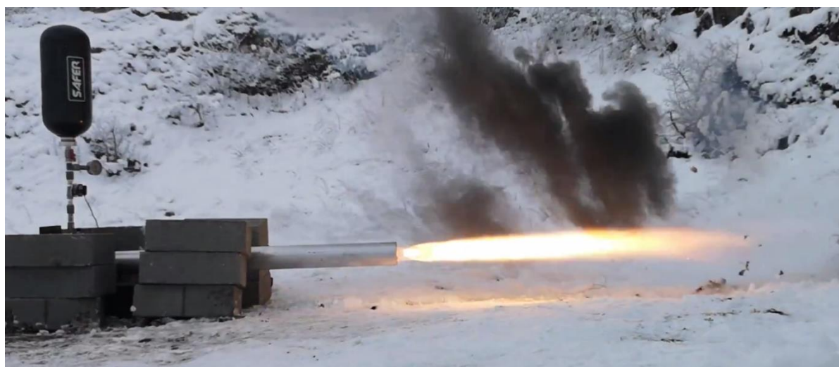
Rys. Test statyczny hybrydowego silnika raketowego
