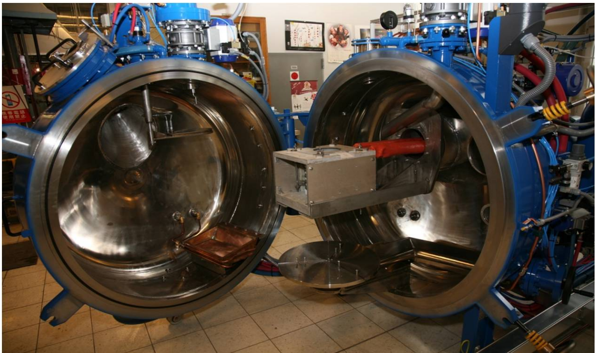
Rys. 1 Laboratoryjny indukcyjny piec próżniowy VIM 10 ÷ 20
