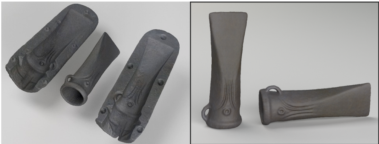
Rys.1. Wizualizacja siekierki, razem z formą odlewniczą
