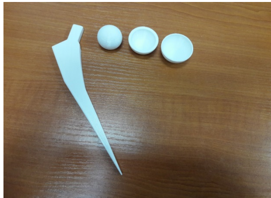
Rys. 1 Zdjęcie przedstawia komplet części modelu endoprotezy stawu biodrowego wydrukowanej z PLA
